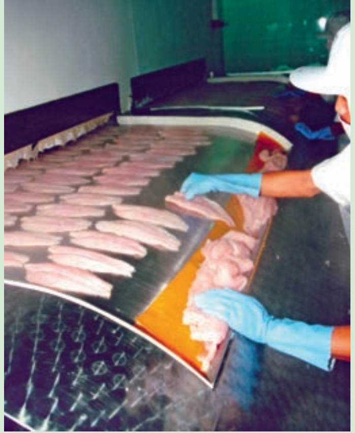
Dondurulmuş balık filetoları taşıma bandına itina ile yerleştirilmelidir; aksi takdirde, dondurulduklarında bazen göze hoş görünmeyen bir şekil alırlar.
