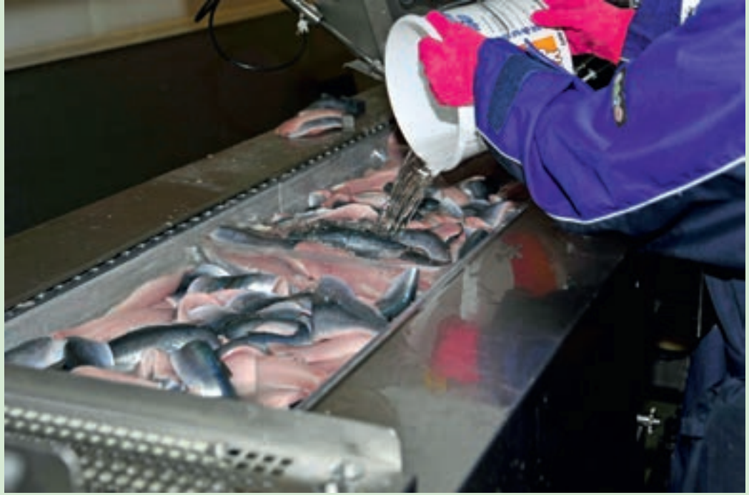
Yağ oranı çok yüksek olan deniz ürünlerinden yapılan blokların kırılma riskini azaltmak için, ürünler derin dondurulmadan önce stabilize edilmek üzere genellikle su ile doldurulurlar.
