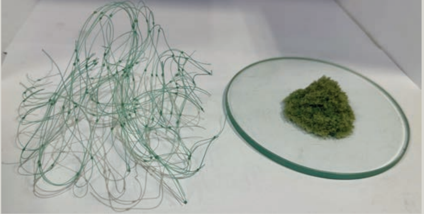
Ağlar tasnif edildikten sonra, uygun olduğu tespit edilenler ince bir toz haline gelene kadar ufalanıyor (sağda). Bu toz baştaki malzemeyle aynı düzeyde mukavemet ve esnekliğe sahip
