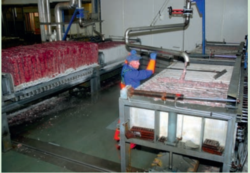
Dikey plakalı dondurucular üstten kolayca doldurulabilir. Örneğin, burada, balık unu fabrikasına teslim edilmeden önce bloklar halinde derin dondurulan şaft atığı görülmektedir.
