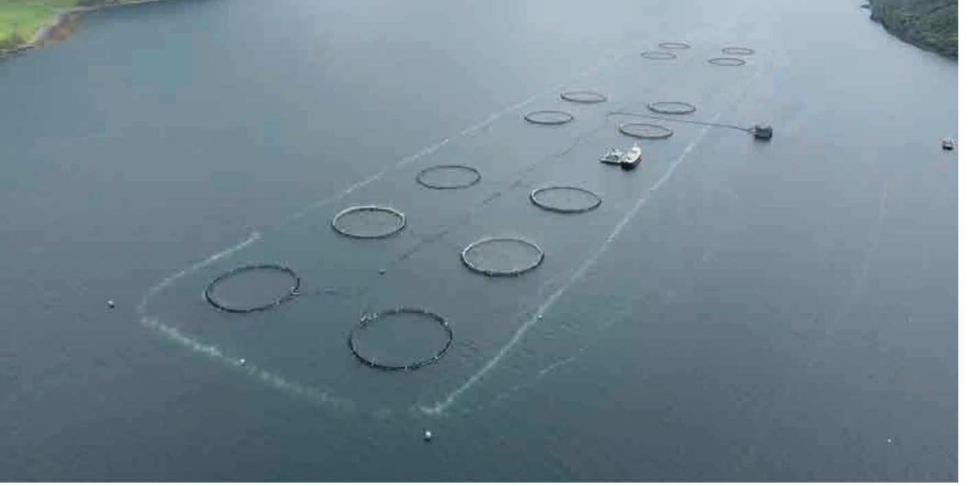
Mowi Scotland tarafından geliştirilen kabarcık perdeleri, somon kafeslerinin etrafında koruyucu bir bariyer oluşturarak, aşırı artan denizanası popülasyonlarının yol açtığı zararı azaltmaya yardımcı oluyor.
