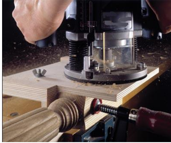
Resim 2.12: El freze makinesinde yüzey şekillendirme
