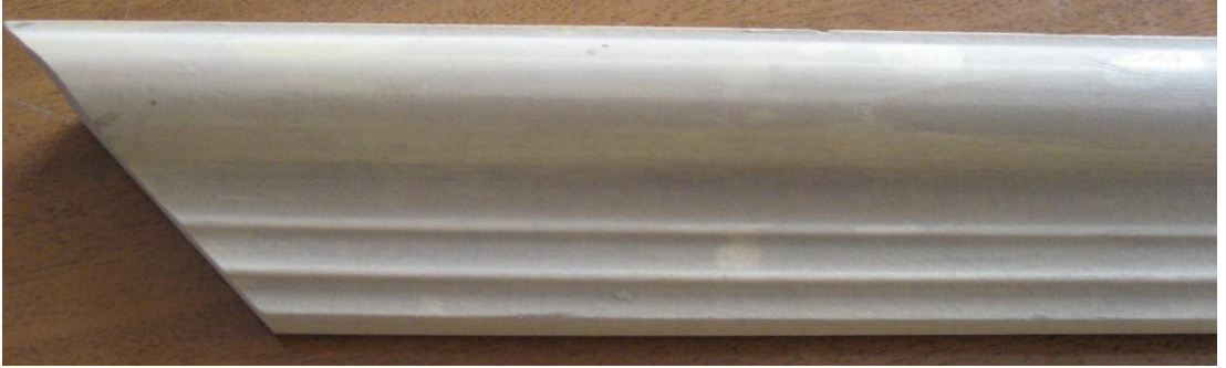
Resim 1.29: Yatay freze makinesinde açılmış çerçeve kordonları
