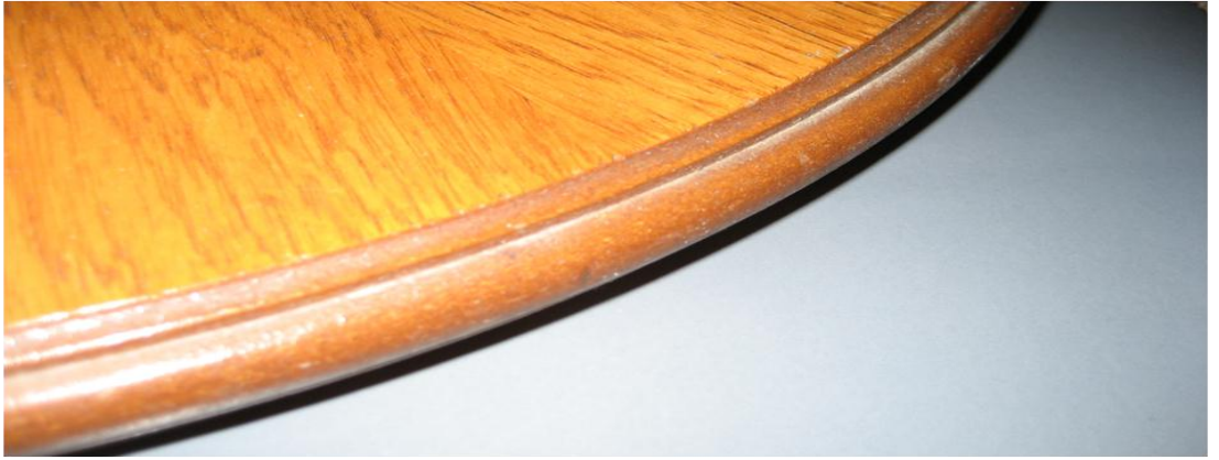
Resim 1.32: Dairesel iş parçasına rulmanlı bıçakla profil açma
