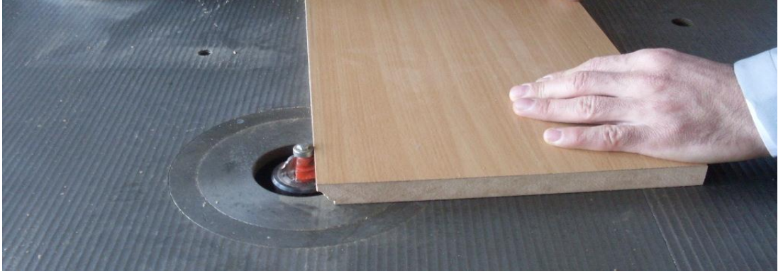
Resim 1.30: Kısa milde rulmanlı bıçakla profil açma
