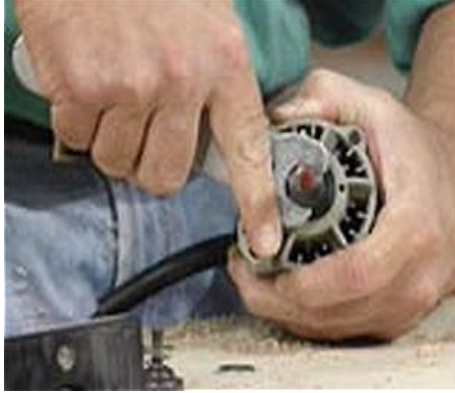
Resim 2.8: El Freze Makinesi bıçaklarının sökülmesi
