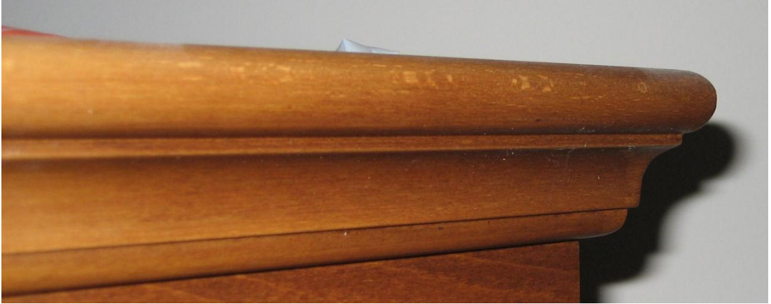
Resim 1.27: Yatay freze makinesinde açılmış bir kordon
