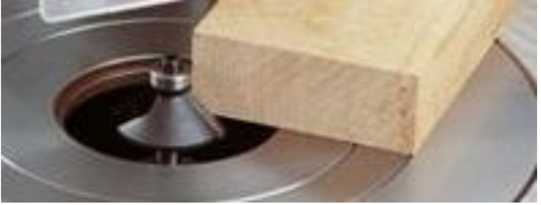
Resim 1.31: Kısa milde rulmanlı bıçakla profil açma
