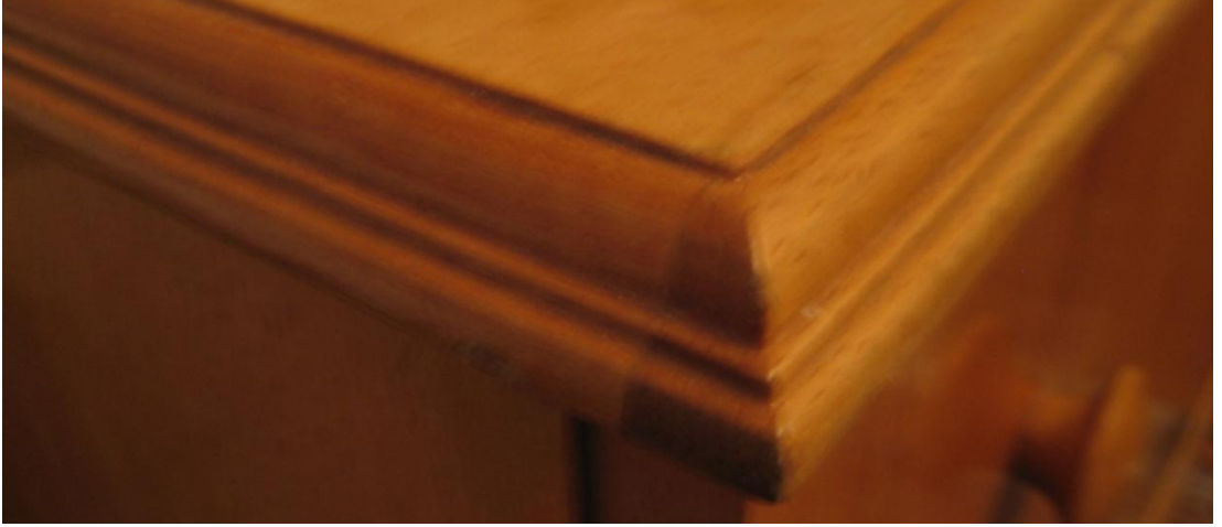
Resim 1.28: Yatay freze makinesinde açılmış bir kordon
