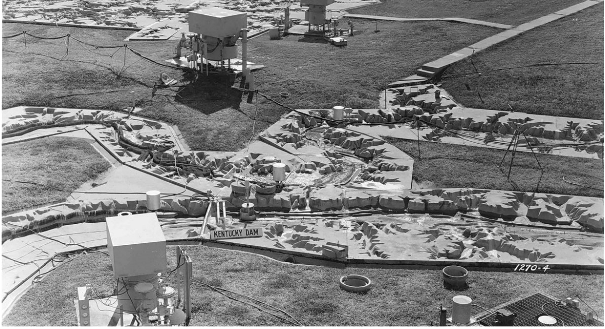
Şekil 11.4 Misisipi Nehri Havzası'ndaki akım koşulları analiz etmek amacıyla açık arazide kurulmuş fiziksel bir model
