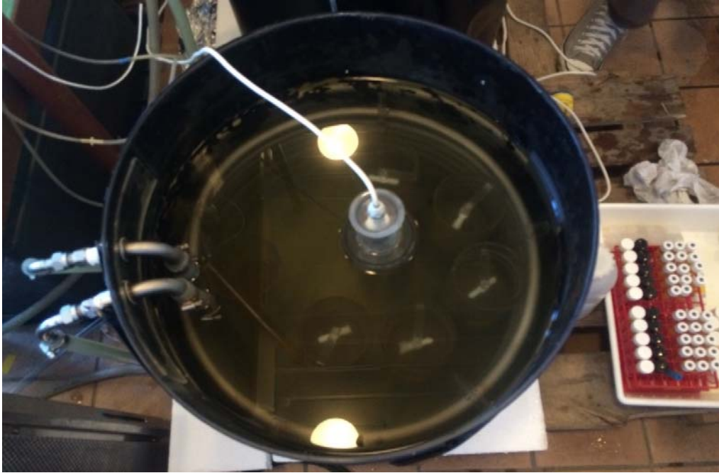
Şekil 11.3 Fitoplanktonun farklı çevresel koşullara tepkilerini araştırmak amacıyla laboratuvar ortamında kurulmuş fiziksel model
