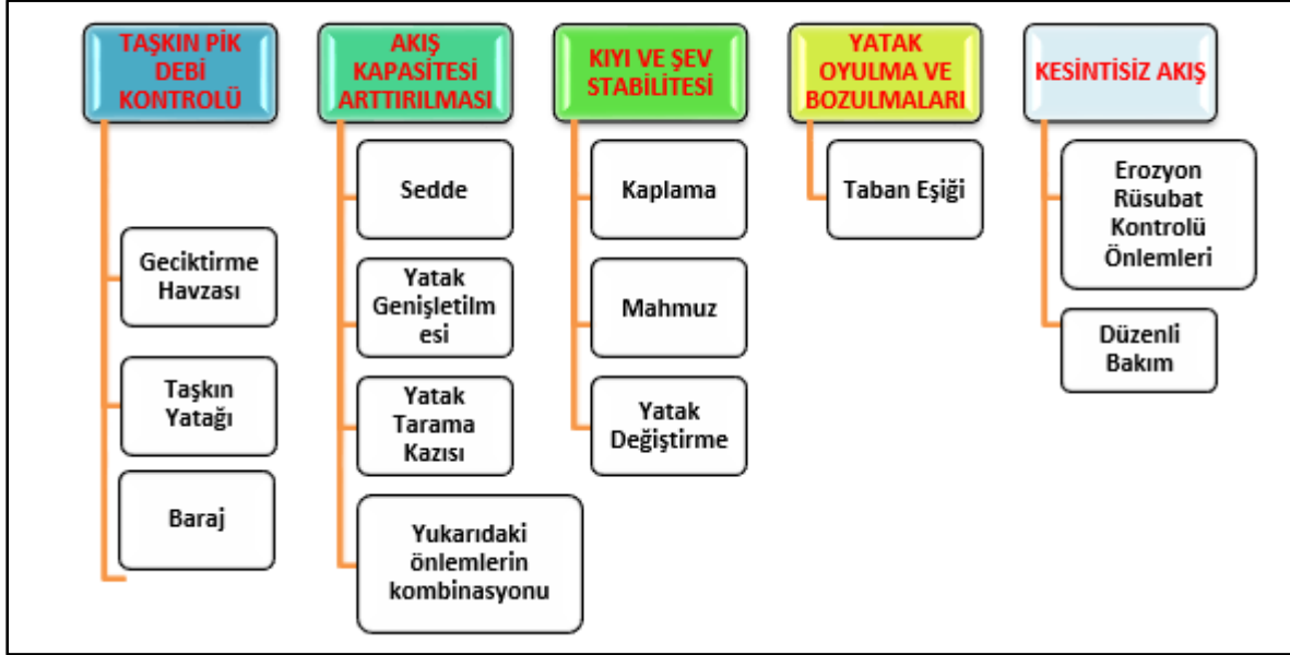
Şekil 2-12: İslah ve Taşkın Kontrolü Önlemlerinin Genel Sınıflandırılması
