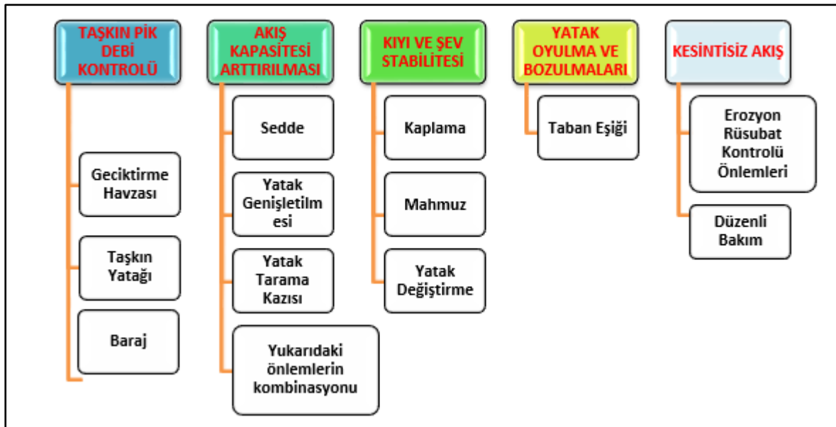
Şekil 2-19: Islah ve Taşkın Kontrolü Önlemlerinin Genel Sınıflandırılması
