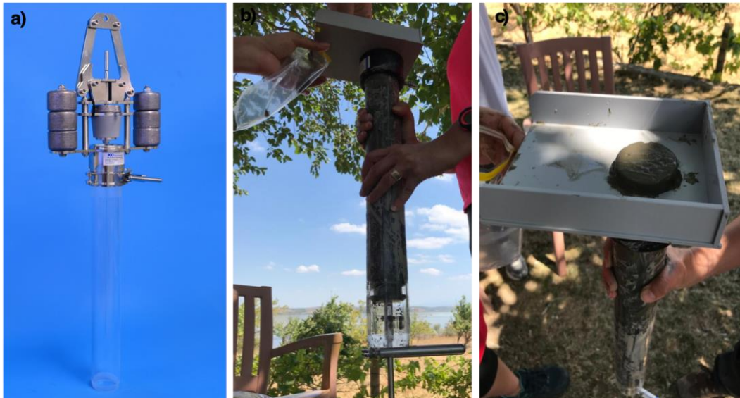
Şekil 3.7 a) KC-Denmark Kajak Corer (REF), b-c) Arazi örnekleme (Fotoğraf: ©Ü.N. Tavşanoğlu, 2020)
