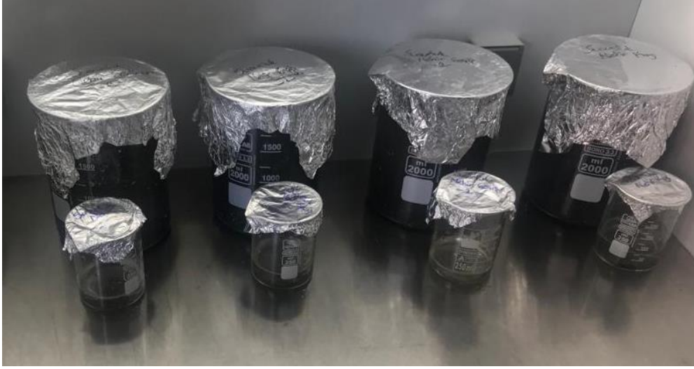
Şekil 4.2 Sediman örneklerinde mikroplastik yüzdürme işlemleri (Fotoğraf: ©Ü. Aytan, 2021)
