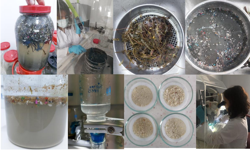
Şekil 4.1 Biyolojik içeriği yüksek örneklerde mikroplastik analizi ön işlemleri (Fotoğraf: ©Ü. Aytan, 2021)
