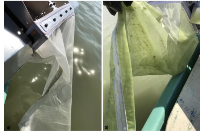
Şekil 3.5 Aynı süre örneklem yapılan farklı göz açıklığına sahip manta kepeçleri: a) 330 \mu\text{m} , b) 100 \mu\text{m} (Fotoğraf: ©Ü.N. Tavşanoğlu, 2020).
