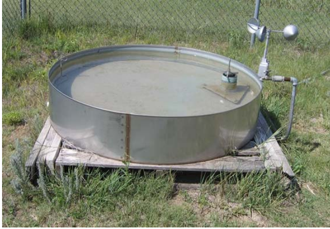
Şekil 3.5 Standart A-tipi buharlaşma kabı
