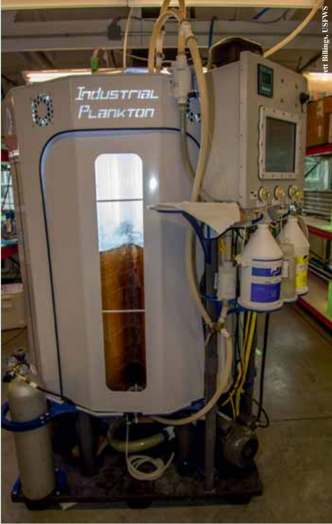
Tatlısu midyeleri için yem olarak üretilen kahverengi yosunların yetiştirilmesini sağlayan plankton reaktörü
