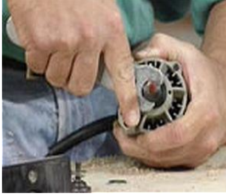
Resim 2.8: El Freze Makinesi bıçaklarının sökülmesi
