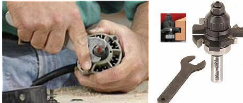
Resim 2.13: El freze makinesinin bıçağının sökülmesi
