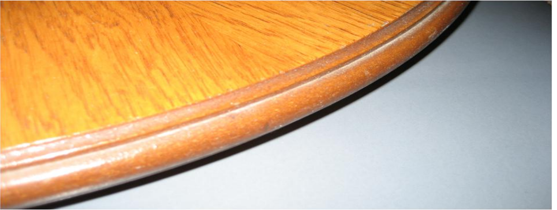
Resim 1.32: Dairesel iş parçasına rulmanlı bıçakla profil açma
