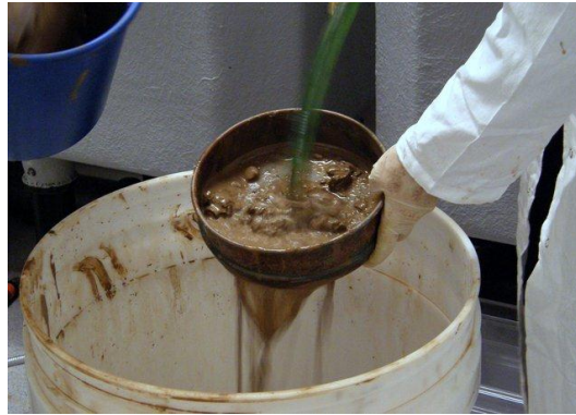
Şekil 4.10 Sedimanın su ile ıslatılması [22]
