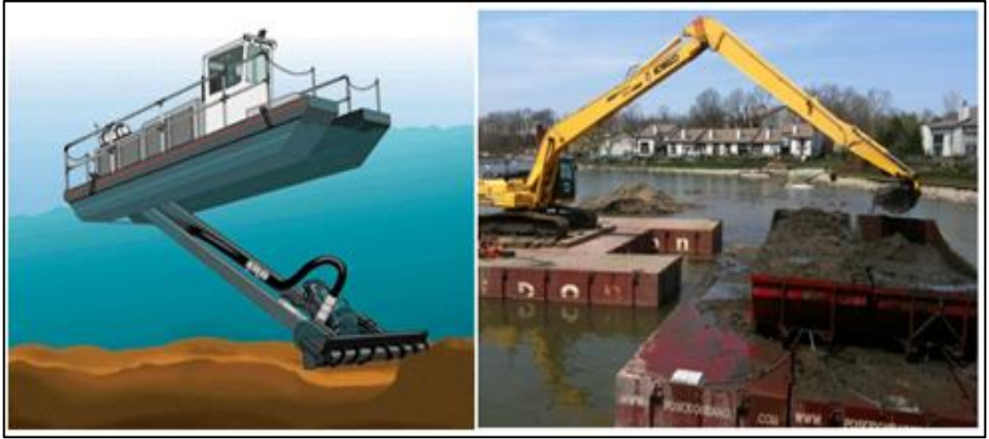
Şekil 6. Hidrolik (sol) ve Mekanik (sağ) Dip Tarama Uygulamaları [76]
