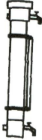
Şekil 2.4: Fitoplankton numunesi alma şişesi (Nansen şişesi)
